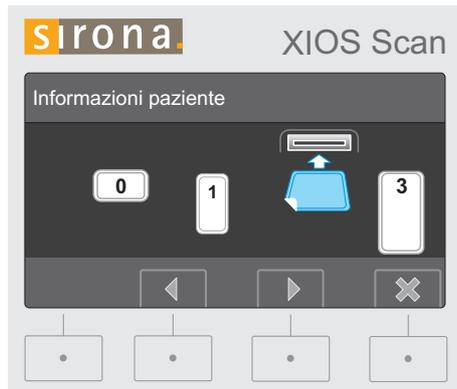
☞ Il carrello si muove nella dimensione preimpostata della piastra per imaging. L'impostazione di fabbrica per la dimensione delle piastre per imaging è 2.
