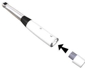
Per estrarre la batteria, premere il pulsante **Rilascio batteria** (A) ed estrarre delicatamente la batteria.
