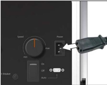
1. Inserire il cavo di rete nel rispettivo collegamento sul sistema di aspirazione.
