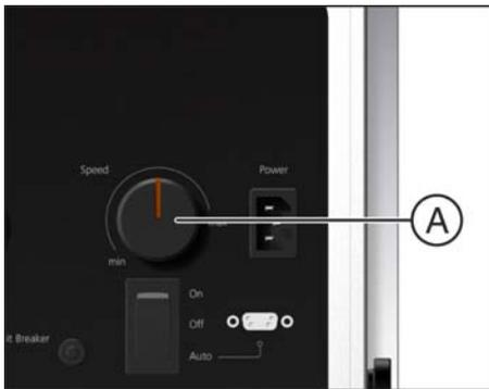
Con il regolatore rotativo (A) è possibile impostare la potenza di aspirazione.
