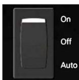
3. Attivare il funzionamento manuale del dispositivo di aspirazione, portando l'interruttore che si trova sulla parte superiore del dispositivo da "Auto" a "On"
