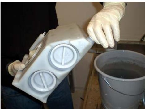
3. Aprire l'apertura di scarico (D). Nel fare ciò inclinare il serbatoio in modo che il liquido non fuoriesca dall'apertura di scarico.
