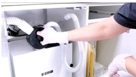
2. Ruotare l'adattatore nero del set di pulizia manuale con tubo dall'aspirazione della camera all'aspirazione attraverso il tubo di pulizia manuale.
