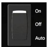
3. Attivare il funzionamento manuale del sistema di aspirazione, portando l'interruttore che si trova sulla parte superiore del dispositivo da "Auto" a "On"
