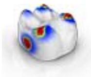
Se viene modificato un restauro, si spostano anche le superfici di contatto. Con lo strumento *"Regola punti di contatto"* viene ripristinato lo spessore dei contatti impostato nei parametri.
