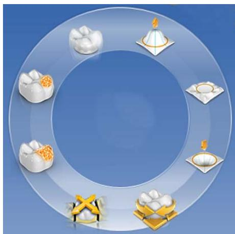
La ruota degli strumenti mette a disposizione nella fasi AMMINISTRAZIONE, MODELLO, PROGETTAZIONE oppure FABBRICAZIONE gli strumenti più utilizzati, per semplificare l'accesso agli stessi. Gli strumenti messi a disposizione dipendono dal passaggio in corso.
