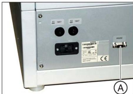
Sul retro dell'apparecchio è posta un'interfaccia seriale (A) di tipo RS232. L'utilizzo di questa interfaccia è riservato al tecnico dell'assistenza ed è descritto nel Manuale di assistenza.
