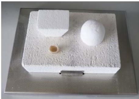
1. Sollevare il crogiolo con l'ausilio della pinza per crogioli dallo sportello del forno e posizionarlo sul supporto resistente al fuoco in dotazione.
