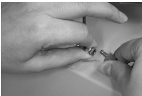
2. Estrarre dal raccordo il tubo flessibile dell'alimentazione dell'argon dello sportello con allacciamento del gas.
