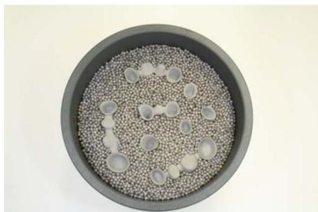
1. Riempire la ciotola per sinterizzazione con perle di ossido di zirconio. L'altezza di riempimento dovrebbe essere compresa tra 1,5 e 2 cm. Utilizzare per questo esclusivamente le perle di ossido di zirconio per la sinterizzazione NEM (RIF 64 13 640).
