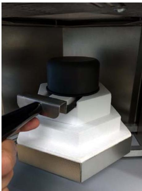
4. Al termine del processo di sinterizzazione è possibile estrarre dal forno il set di sinterizzazione inCoris CC con l'ausilio della pinza per crogioli e lasciarlo raffreddare all'esterno del forno stesso.
