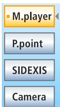
Le applicazioni PC sono avviate automaticamente dal riunito. Sul touch screen un quadrato di colore arancione posizionato prima del campo di ciascuna applicazione PC segnala se l'applicazione sul PC è avviata e pronta all'uso. Finché il quadrato di colore arancione non viene visualizzato, la comunicazione con l'applicazione PC non è ancora possibile.
