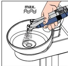
1. Prelevare gli strumenti che devono essere risciacquati e tenerli al di sopra della bacinella o di un recipiente impermeabile di capacità adeguata. Nell'elemento medico CS: portare i braccetti oscillanti degli strumenti da risciacquare nella posizione di lavoro, in modo che il peso dei cordoni degli strumenti consenta di mantenerli in questa posizione.
