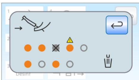
Il programma di sanificazione è in grado di stabilire se la sanificazione è stata completamente conclusa per tutti gli strumenti e per il dispositivo di riempimento del bicchiere. Se durante la sanificazione si è verificato un errore, questo viene visualizzato sul touch screen:
