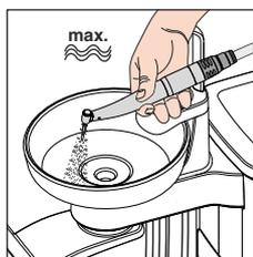
1. Tenere la siringa a tre vie dell'elemento medico e dell'elemento assistente sopra la bacinella o un recipiente impermeabile di capacità adeguata e premere il tasto dell'acqua per almeno 15 secondi.
