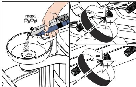
1. Impostare al massimo il flusso di acqua su tutti gli strumenti dinamici e sul dispositivo per la rimozione del tartaro. I regolatori dell'acqua sotto la tavoletta strumenti devono essere girati in senso antiorario.
