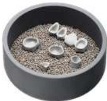
1. Riempire il contenitore per metallo sinterizzato con l'intero contenuto di un flacone di perle per la sinterizzazione di metallo sinterizzato (REF 6413640).
